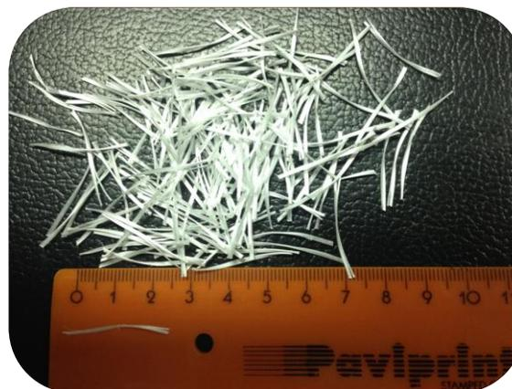
Según Anejo 14 Hormigón con Fibras de la EHE, las características geométricas de las fibras (Longitud ( $l_f$ ), Diámetro equivalente ( $d_f$ ), Esbeltez ( $\lambda$ ), establecidas de acuerdo con **UNE 83.500-1:89** y **UNE 83.500-2:89**, son las siguientes
