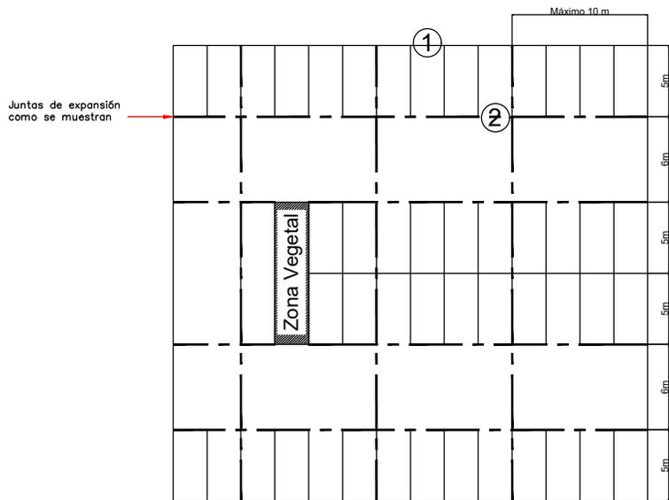
Diseño típico longitudinal de área de aparcamiento de flujo abierto de dos vías
